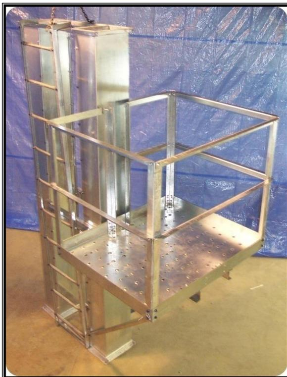
Para acceder a la plataforma desde la escalera debe salir de la jaula de seguridad de la escalera hacia la plataforma y para esto debe remover o modificar uno o dos líneas verticales de la jaula de seguridad y tener acceso fácil. Por razones de seguridad **no** recomendamos remover toda la jaula de seguridad en esta área.
